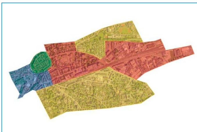
Figura 3: Rappresentazione schematica di una pianificazione energetica comunale, con disposizioni di intervento specifiche riferite ai singoli comparti per i fornitori di servizi energetici e per i fornitori di gas nella zona insediativa (PLANAR 2018)
